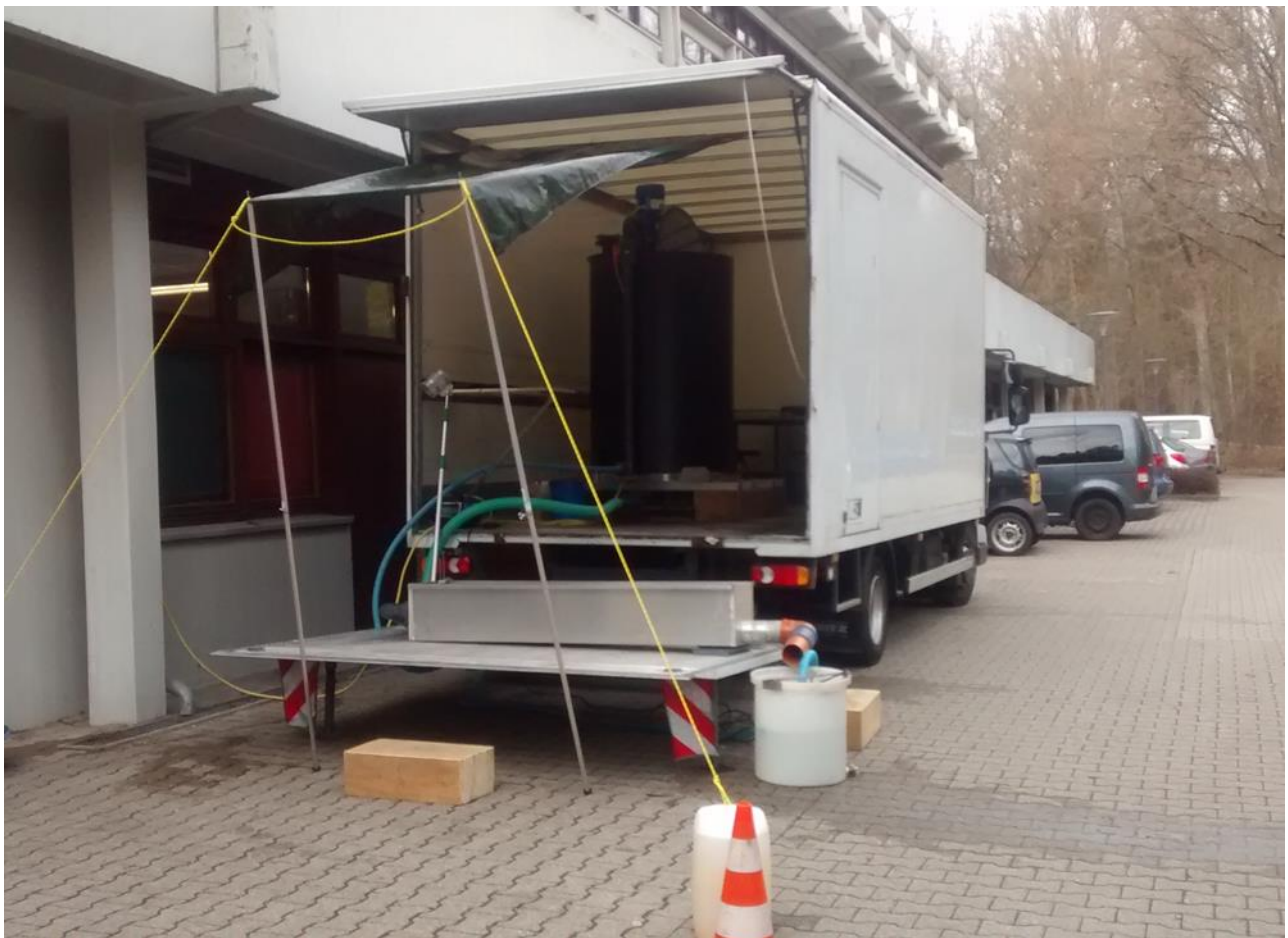
Abb. 1: Mobile Anlage zur Probennahme von Abwasser
